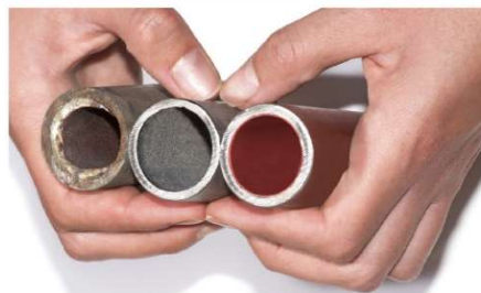
rostiges, gereinigtes, beschichtetes Rohr
