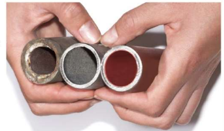
rostiges, gereinigtes, beschichtetes Rohr
